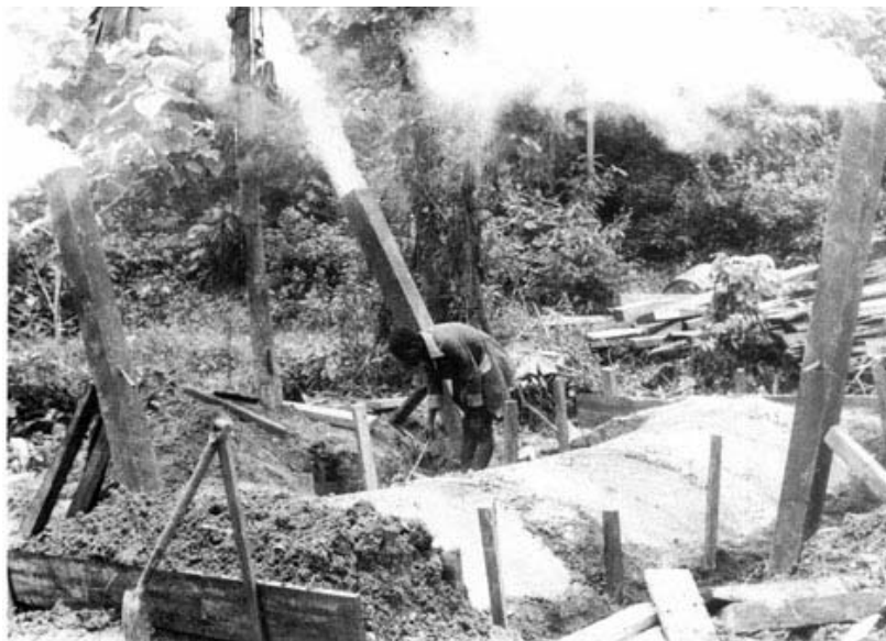
Figura 5. Carboneo tradicional en fosas (ineficiente y contaminante).
