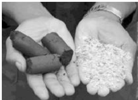
Figura 6. briquetas de cáscara de café carbonizada
