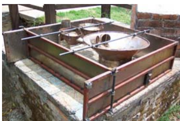
Foto 6. Molde para la construcción de estufa Patsari
