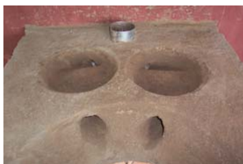
Foto 2. Túneles y hornillas secundarias
