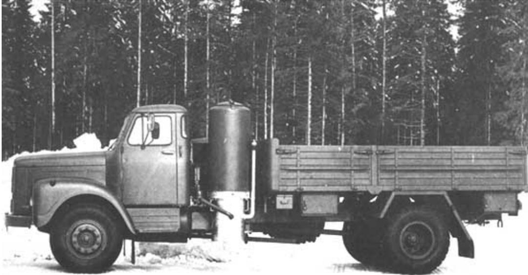
Figura 2-17: Fotografía de un camión Scania L8050 adaptado para funcionar con gas de madera. Fuente No. 152
