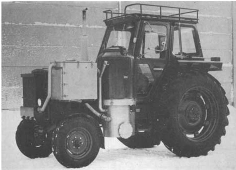
Figura 2-16: Tractor agrícola Massey adaptado para funcionar con gas de madera. Fuente No. 152
