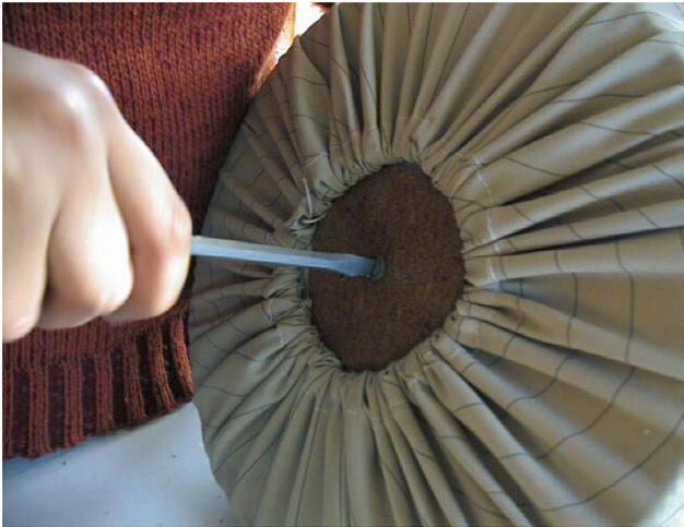
Para manipular la es necesario instalar un tirador de madera, atornillado y reforzado con 2 golillas de cholguán.
